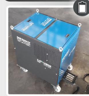
Kompakt, schmaler und leichter als die Version "FULL" und kann mit verschiedenen Batteriesystemen versorgt werden. Geeignet für den kurzen Einsatz und kann die FST8 und FST15 selbstfahrenden Fahrwerke angeschlossen werden. Hydraulikaggregat mit Pumpenmotor die von einer Elektronik gesteuert wird. Proportional-Hydraulikverteiler für eine hohe Sensibilität und exzellente Traktionskontrolle.
