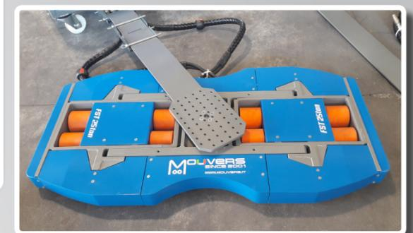
Apollo System 2.0 ist ein modulares Transportsystem, welches das Wachstum Ihres Unternehmens begleitet! Eine Serie von 4 verschiedenen Hydraulikaggregaten für Kraft und Leistung, die an 3 verschiedene selbstfahrende und gelenkte (FST) Fahrwerke angeschlossen werden können. Mit Tragfähigkeiten an den Trägerplatten von 8 bis 25 Tonnen, die mit verschiedenen hinteren Fahrwerken (RT) kombiniert werden können, um eine Tragfähigkeit von bis zu 75 Tonnen erreichen.
