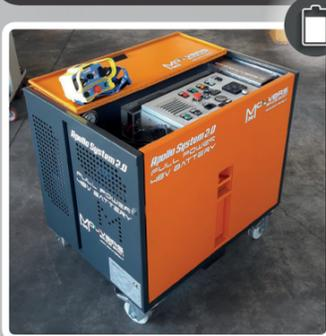
Version mit 48-Volt-Traktions-Batterien für eine große Leistungsdauer und optimale Autonomie. Hydrauliksystem mit Kolben Pumpe mit variabler Fördermenge, Proportional-Steuerung mit Load-Sensing-System. Ladesystem zur optimalen Ladung der Batterie. Kontrolle der Traktion, stufenlose Verstellung der Geschwindigkeit bei konstantem Drehmoment.
