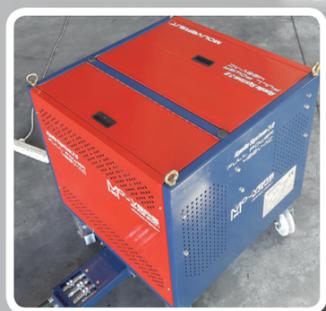
Zentrale mit Dreiphasen-Drehstrom. Anfahrregelung "soft start" komplett mit variabler Kolbenpumpe und proportionaler Steuerung mit Load-Sensing. Luft/Öl Kühler für den Dauereinsatz serienmäßig. Die richtige Wahl für die die schwierigsten Einsätze.
