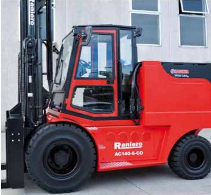
TGV – Ganzstahlkabine mit Türen, Scheiben und Wischern Kippbare Kabine (Option)
