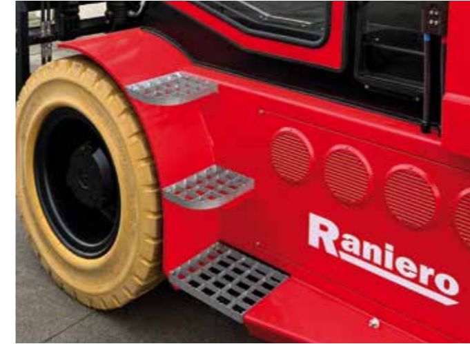
Einfacher Aufstieg mit Rutschsicherung
