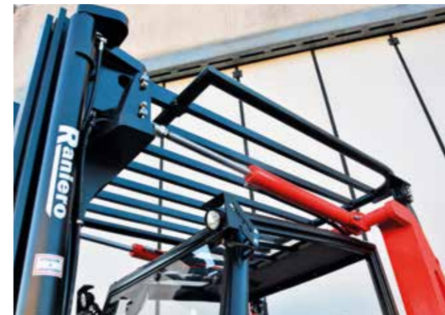
Schutzgrill über der Kabine nur für HT Modell
