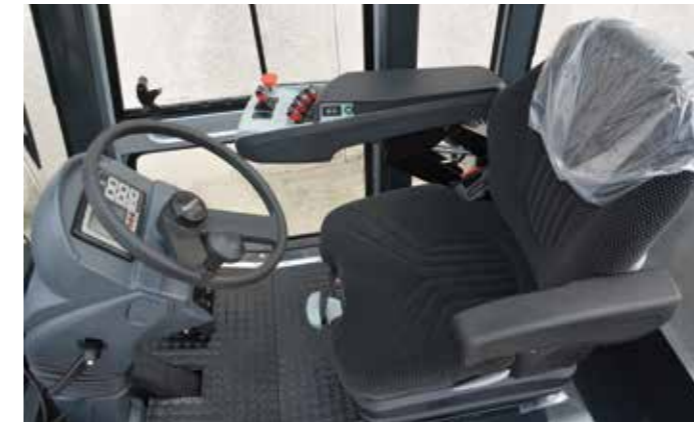
Ergonomischer und mehrfach verstellbarer GRAMMER XL Sitz, mehrfach verstellbare Lenksäule Steuerblock oder elektrohydraulische Hubsteuerung mit Minifinger
